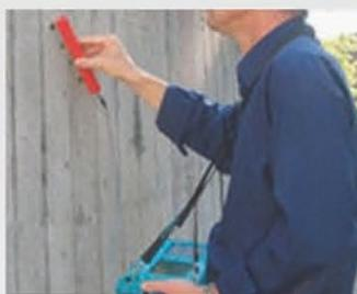
آزمایش تعیین وضعیت خوردگی در سازه‌ها
