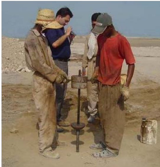
شکل 2- استفاده از کاوشگر دینامیکی متوسط در مناطق جنوبی ( خدایپرست ، 1384 )
