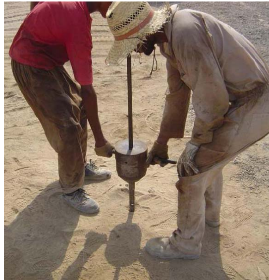
شکل 2- استفاده از کاوشگر دینامیکی متوسط در مناطق جنوبی ( خدایپرست ، 1384 )
