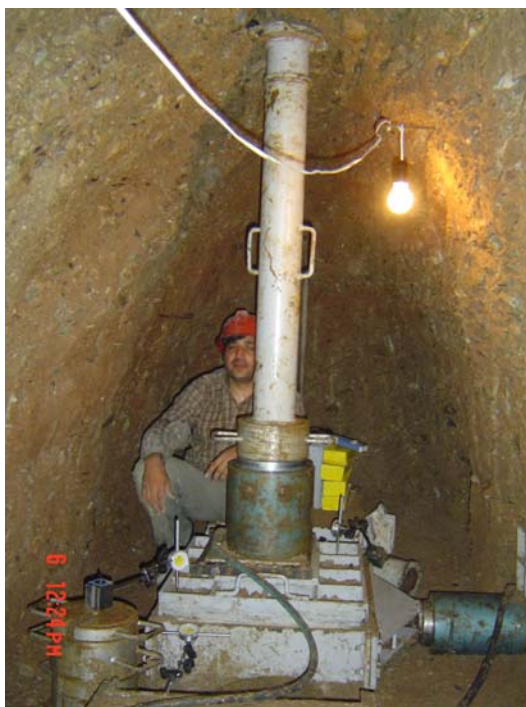
شکل 1- انجام آزمونهای بارگذاری صفحه (سمت راست) و برش برجا (سمت چپ) در آبرفتهای درشت دانه تهران در داخل گالری (چشمی، 1385)
