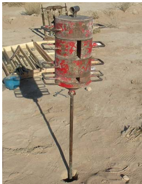
شکل 3- نمای کلی ابزار نفوذ وزنی سوئدی ( شکل چپ ) و مخروط نوک ابزار نفوذ وزنی ( اشکال راست ) ( حبیبی ، 1385 )
