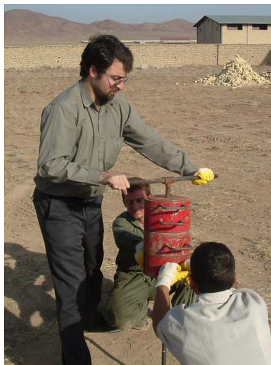
شکل 4- بکارگیری ابزار نفوذ وزنی سوئدی در مناطق جنوبی تهران (حبیبی، 1385)
