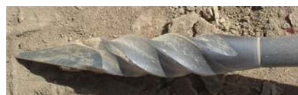
شکل 3- نمای کلی ابزار نفوذ وزنی سوئدی ( شکل چپ ) و مخروط نوک ابزار نفوذ وزنی ( اشکال راست ) ( حبیبی ، 1385 )
