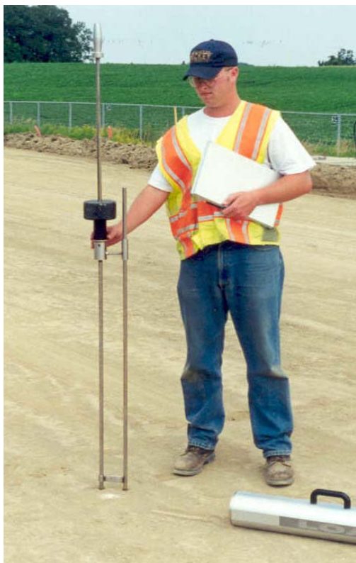
شکل ۴- بکارگیری ابزار نفوذ دینامیکی مخروط برای کاوش زمین
