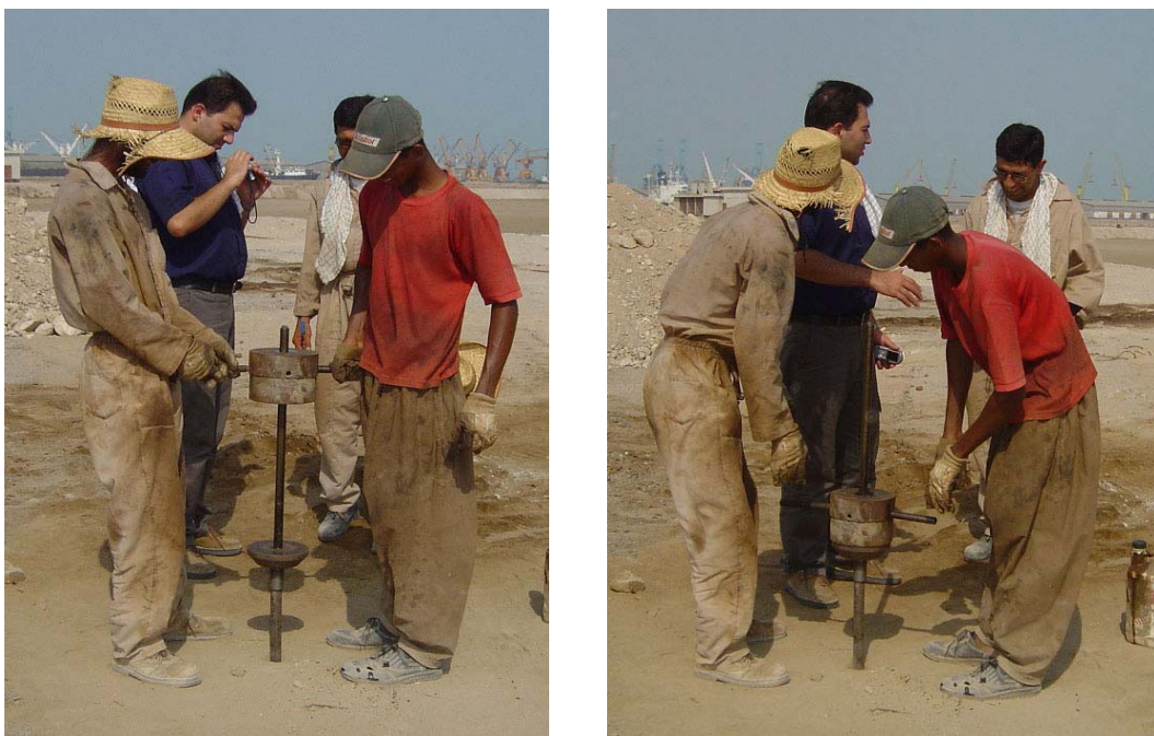
شکل ۶- بکارگیری کاوشگر دینامیکی متوسط در بندر شهید رجایی بندر عباس (۱۳۸۳) (خداپرست، ۱۳۸۴)
