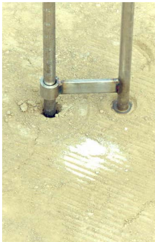
شکل ۴- بکارگیری ابزار نفوذ دینامیکی مخروط برای کاوش زمین
