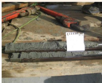
نمونه‌های اخذ شده از بستر دریا با استفاده از نمونه‌گیر SPT
