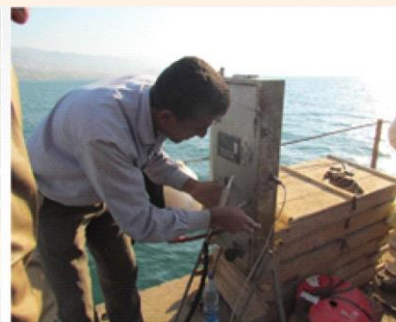
انجام آزمایش پرسیمتری در دریا
