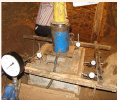
انجام آزمایش برش برجا در چاهک
