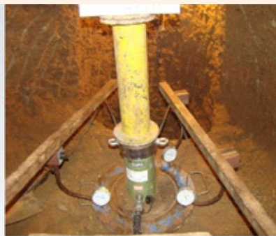
آزمایش بارگذاری در صفحه‌ای در چاهک
