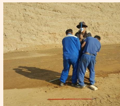
انجام آزمایش کاوشگر دینامیکی
